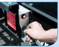
Lorsque le crochet est monté sur une traverse difficile d'accès (sous le porte-à-faux par exemple), il est possible de l'associer à une commande à distance. Celle-ci rend les manipulations plus simples, rapides et faciles pour le chauffeur.
