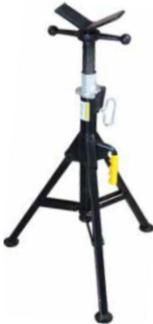
Alle Rohrstativ werden mit einem standardmäßigen V-Kopf und Sicherheitsring geliefert, um ein unerwartetes Zusammenfallen und Handverletzungen zu vermeiden. Die faltbare Version mit Tragegriff ermöglicht ein einfaches Abstellen und einen leichten Transport. Die Tragkraft des Rohrstativs beträgt 1130 kg. Zudem sind die Köpfe austauschbar und unterschiedliche Rollensätze erhältlich.
